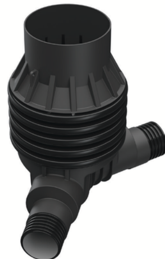
4G mit integrierten Anschlüssen für gerippte Rohre (Ringstifigkeit SN 4, SN 8) (geripptes Rohr für ID 800 und ID 1000 mm)
