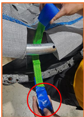
Slika 13.1: Razgrnjen bremenski trak postavite pod nosilni obroč. Uho z etiketo naj bo na spodnji strani.
